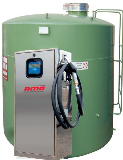
**DIESEL TANK OMOLOGATO M.I. e MARCATURA CE- Serbatoio cilindrico ad asse verticale a doppia parete**, in lamiera di acciaio al carbonio EN 10025, spessore 3 e 2,5 mm. Il serbatoio esterno di protezione ha capacità di contenimento pari al 100% del serbatoio interno. La struttura è sorretta da gonna di supporto e da barre inferiori che permettono la movimentazione a vuoto tramite muletto.
