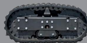
Cingolatura in gomma con scolpitura per una trazione ottimale. Il modulo cingolo è azionato da un sistema di trazione diretta con due ruote motrici dentate in acciaio. Ciò riduce la pressione sul terreno, aumenta l'aderenza e minimizza la resistenza durante lo spostamento (attrito volvente). Questa configurazione migliora il galleggiamento, riducendo il rischio di affondamento su terreni morbidi.
