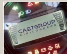
Display elettronico con spie anomalie, luci, motore, livelli olio idraulico e sistema elettrico flottaggio.
