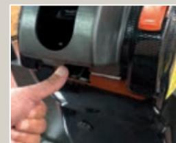
Il piantone dello sterzo è regolabile mediante una semplice pressione della leva posta sotto il volante.
