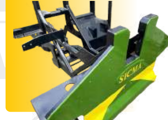
Telaio in elementi tubolari e rinforzati Frame in tubular and reinforced elements
