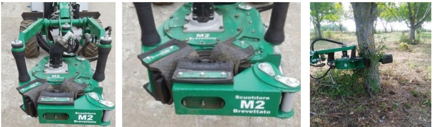
Fig. 9: supporti stratificati in gomma, tenuti assieme da bavette anch'esse in gomma
