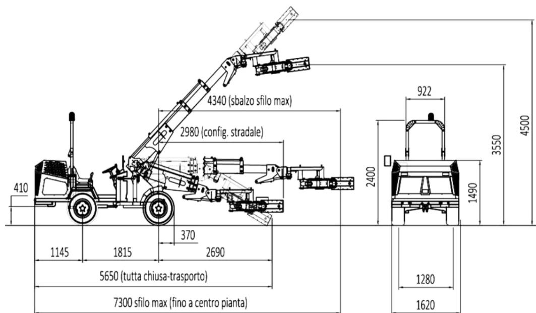
MM20 (ruote 29 x 12.5-15), versione con scuotitore B2: 3200 kg
