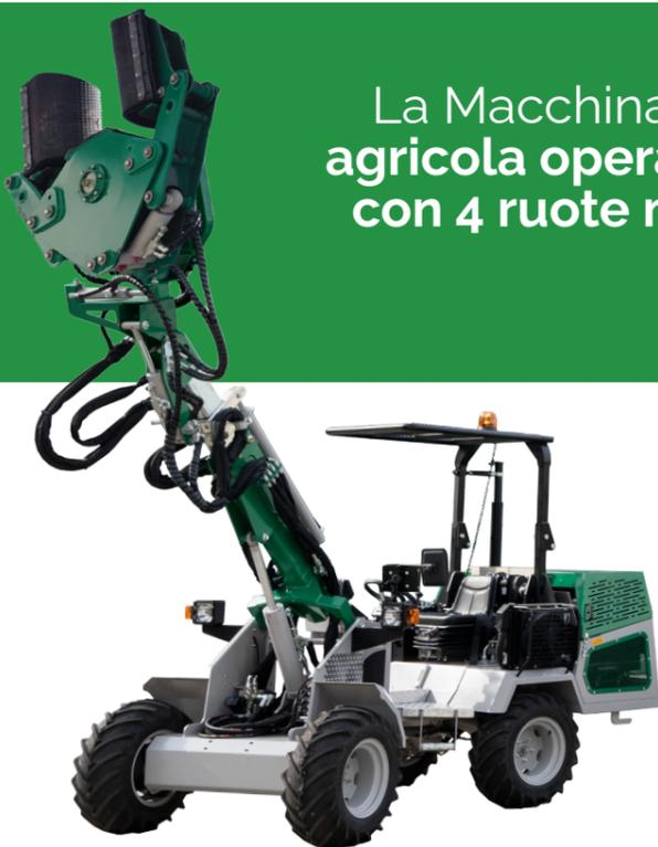
Questa macchina è stata studiata per **usi intensivi, difatti tutta la struttura è stata realizzata per sopportare sollecitazioni molto gravose causate da impieghi continui** e da terreni non particolarmente adeguati. La funzione principale della macchina è di **agevolare la raccolta** di frutti pendenti, ma le configurazioni possibili estendono l'uso della macchina **tutto l'anno**.
