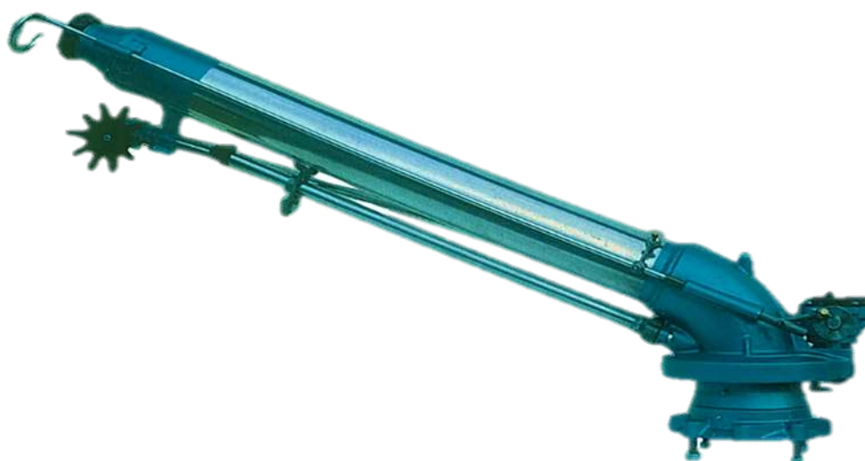
IDEAL 120: Irrigatore di grande portata per alte pressione a lunga gittata, da applicare fisso su pompa con potenza assorbita, di oltre 100HP. Giro circolare e a settori a velocità costante con la regolazione dei settori di semplice impiego, permettendo una rapida installazione ed una facile regolazione dell'arco di irrigazione desiderata.
