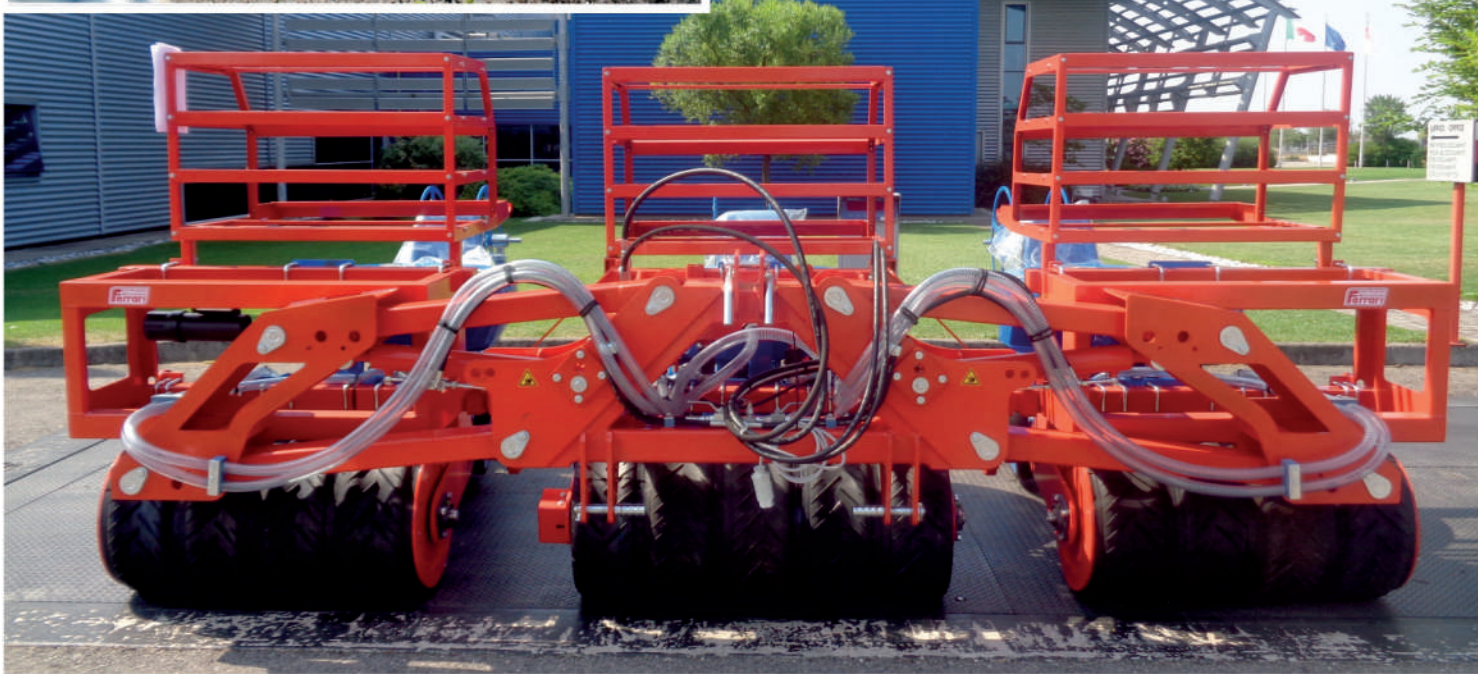
RULLO FLEX | RUBBER ROLLER | ROULEAU AVANT EN FLEX FLEX VORDERWALZE | KATOK FLEX | RODILLO FLEX
