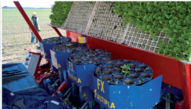
VERSIONE SPECIALE INTERFILA 21 cm. | ROW WIDTH 21 cm. ENTRE RANGS 21 cm. | SONDER ZWISCHENREIHE 21 cm СПЕЦИАЛЬНАЯ ВЕРСИЯ МЕЖДУРЯДЬЕ 21 cm DISTANCIA ENTRE FILAS 21 cm.
