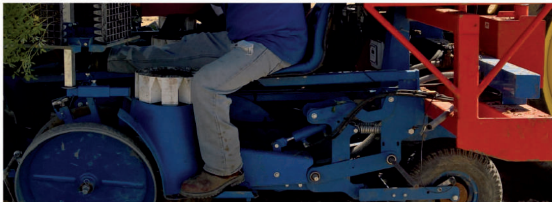
VERSIONE PARALLELOGRAMMA CON PISTONE IDRAULICO / PARALLELOGRAM VERSION WITH HYDRAULIC PISTON / VERSION PARALLELOGRAMME AVEC PISTON HYDRAULIQUE / PARALLELOGRAM AUSFÜHRUNG MIT HYDRAULISCHEM KOLBEN / ВЕРСИЯ ПАРАЛЛЕЛОГРАММ С ГИДРАВЛИЧЕСКИМ ПОРШНЕМ VERSION PARALELOGRAMO CON PISTON HIDRAULICO
