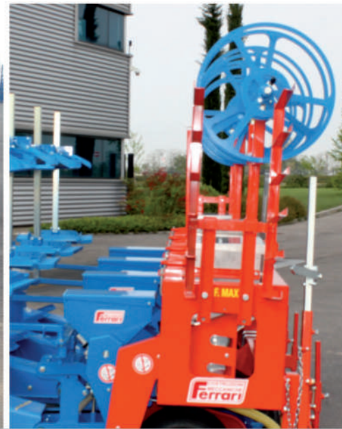
STENDIMANICHETTA CON VOMERE INTERRA MANICHETTA / WATER PIPE STRETCHING TOOL WITH PLOUGH SHARE TO EARTH WATER PIPE UP / SYSTEME POUR ETENDRE LE TUYAU DE L'EAU AVEC SOC OSCILLANT POUR ENTERRE LE TUYAU DE L'EAU / SCHLAUCHLEGEGERÄT MIT SCHLAUCHUNTERPFLUGSCHAR РАЗМАТЫВАТЕЛЬ КАПЕЛЬНОЙ ЛЕНТЫ С ЛЕМЕХОМ УКЛАДЫВАЮЩИМ КАПЕЛЬНУЮ ЛЕНТУ EXTENSOR MANGUERA Y REJA ENTIERRA MANGUERA
