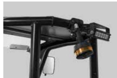
Dettagli come le zavorre integrate ed il lampeggiante abbattibile (optional) aiutano a mantenere sempre al minimo l'ingombro complessivo delle macchine.
