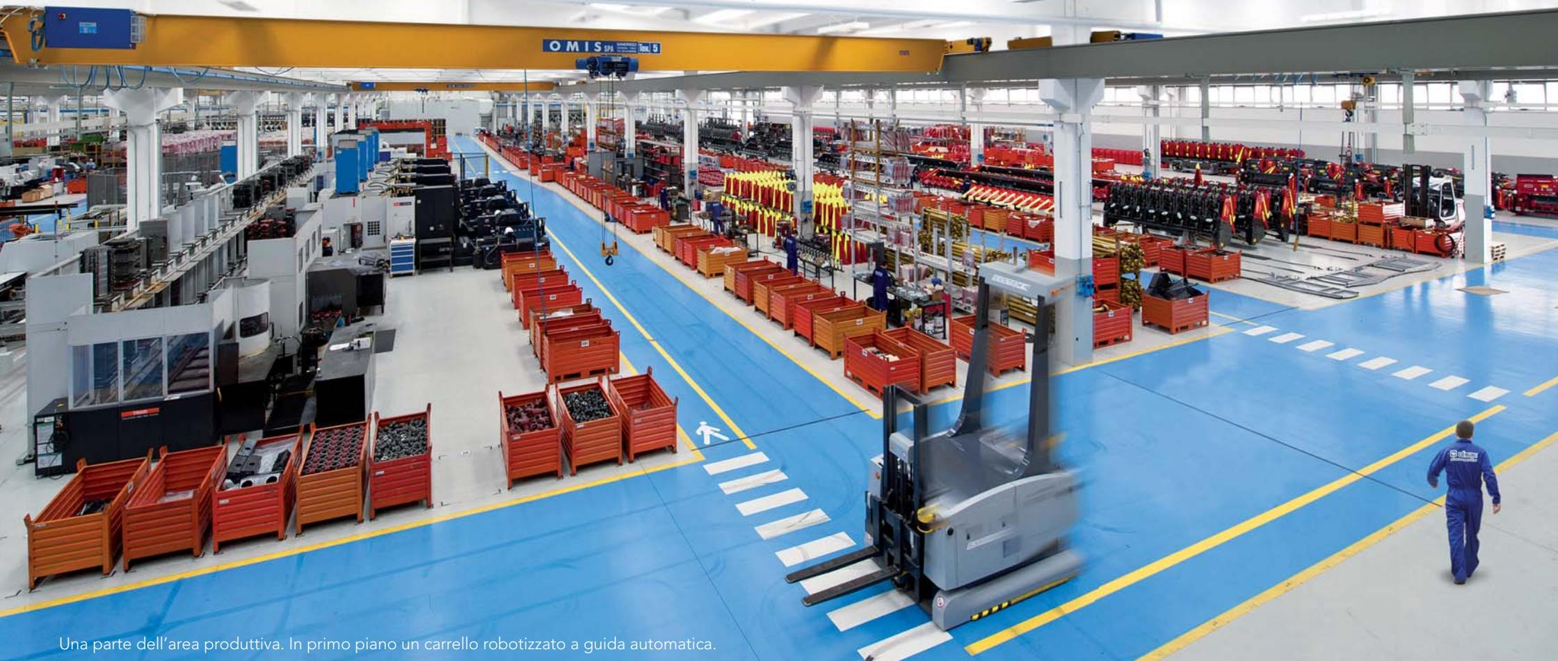
Una parte dell'area produttiva. In primo piano un carrello robotizzato a guida automatica.
