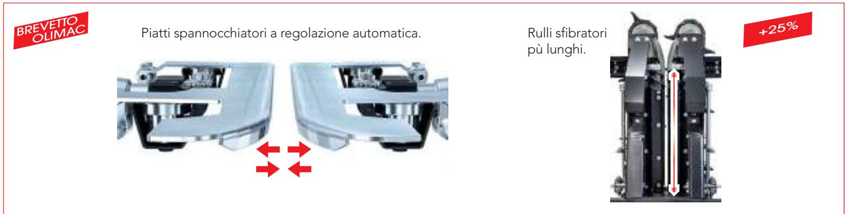
L'apertura dei piatti spannocchiatori si regola automaticamente e simultaneamente a seconda della grandezza degli steli del mais. L'automatismo funziona in modo indipendente su ciascuna fila. Nessun intervento dell'operatore. I rulli sfibratori sono più lunghi, hanno una velocità periferica di rotazione più bassa consentendo un distacco più dolce della pannocchia dalla pianta. Vantaggi: raccolto totale senza perdite, perfetta mungitura dello stocco, più produttività.
