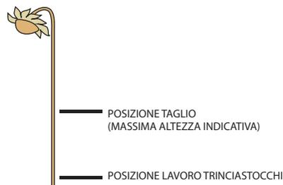
Limitata distanza massima tra altezza di raccolta e altezza di trinciatura
