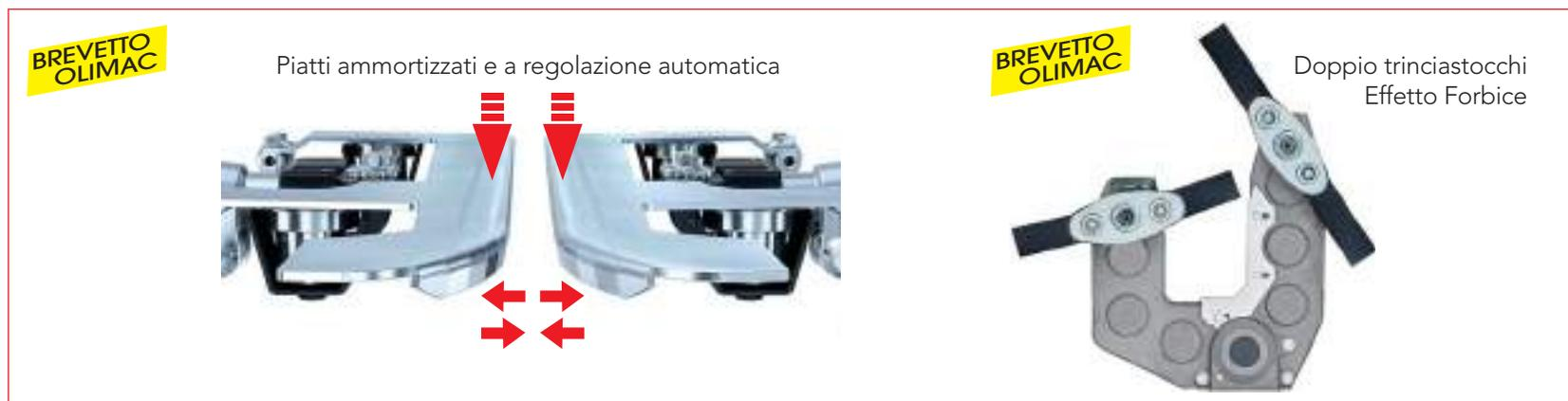
Il dispositivo ammortizzatore attutisce l'impatto delle pannocchie sui piatti, si evitano perdite di prodotto e le pannocchie non rimbalzano fuori. L'apertura automatica dei piatti si adegua continuamente e simultaneamente alle diverse dimensioni degli steli del mais. L'automatismo funziona in modo indipendente su ciascuna fila. Il raccolto è totale, senza perdite.
