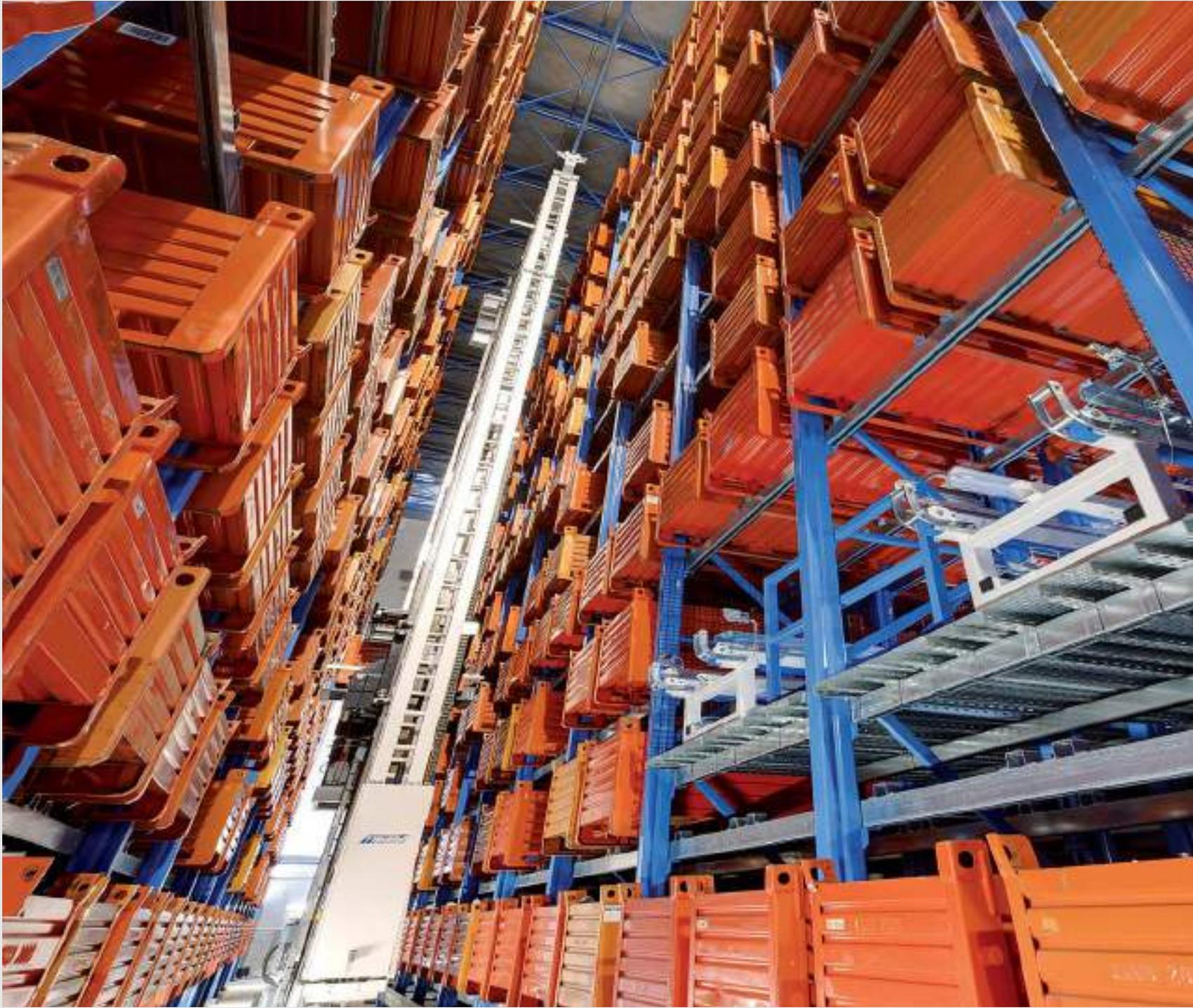
*Interno del magazzino automatico verticale.
