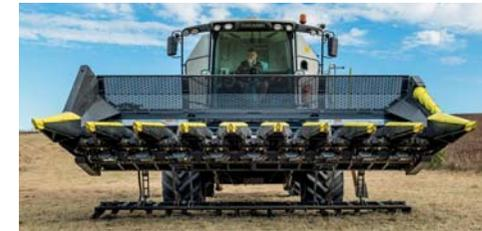
così **si raccoglie solo la testa del girasole senza gambo**, la mietitrebbia lavora più agilmente, il lavoro è più rapido, **il raccolto è totale senza perdite e la trinciatura è ottimale.**
