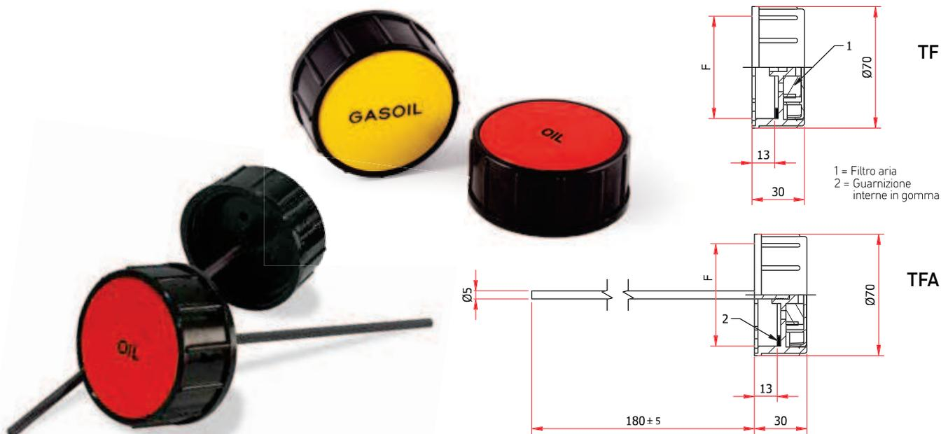
Tappo di riempimento e sfiato con filetto interno per montaggio avvitato su bocchettone.
