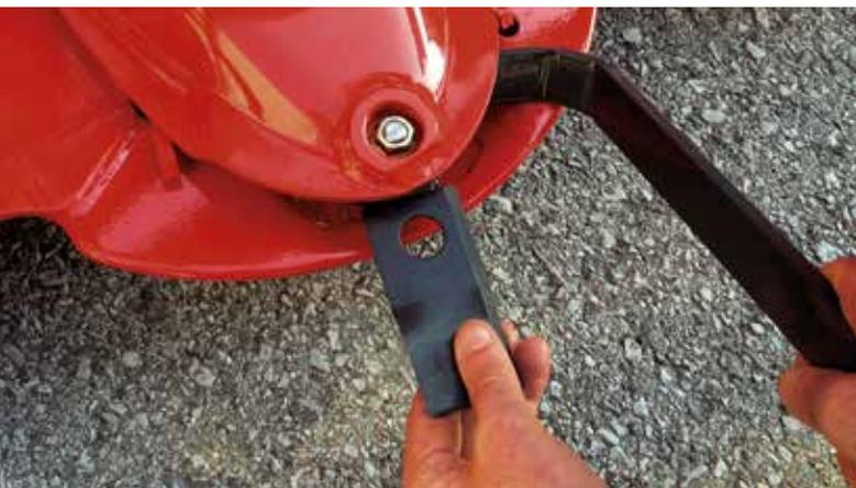
I coltelli sono ad attacco rapido per ridurre drasticamente il tempo di sostituzione senza l'ausilio di chiavi. I dischi falcianti sono realizzati in modo da avere una notevole sovrapposizione dei coltelli e permettere un taglio perfetto anche nel prodotto più fitto e umido.
