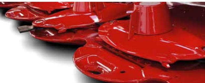
Il profilo conico del disco di taglio è progettato con un design esclusivo ed unico, per permettere al materiale tagliato di confluire verso la coclea alimentatrice in modo sempre regolare e simmetrico.
