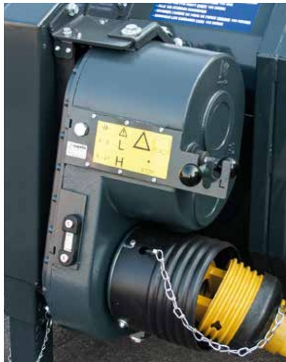
Alimentazione continua e costante: grazie alla scatola di trasmissione integrata (di serie su tutte le macchine) è possibile azionare un cambio di velocità per variare l'alimentazione della coclea e contemporaneamente variare la lunghezza di taglio del raccolto.
