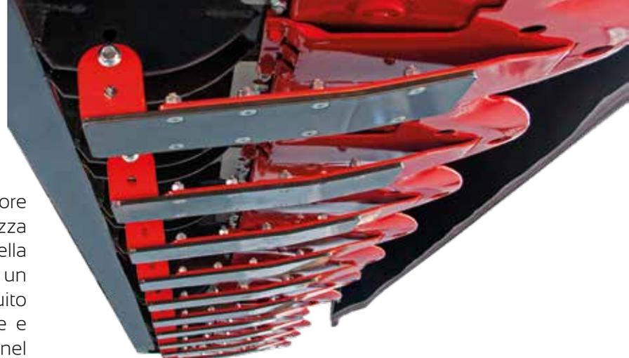
La piastra d'attacco è oscillante e permette di adeguarsi alle asperità del terreno. SPARTAN è adattabile a tutti i tipi e modelli di trincia semovente mediante la semplice sostituzione del kit di adattamento.
