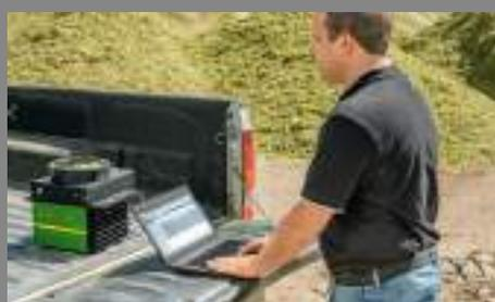
Potete utilizzare il sensore HarvestLab™ 3000 John Deere come un laboratorio fisso o un dispositivo mobile alimentato da un veicolo per ottenere informazioni istantanee che vi consentono di gestire meglio l'eterogeneità del foraggio e del mangime.
