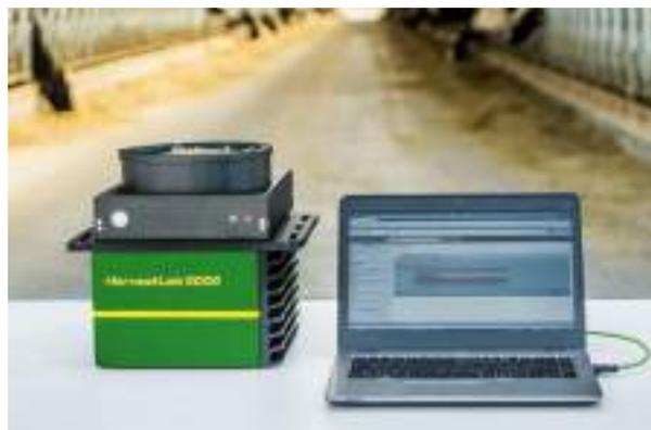
Inoltre, HarvestLab™ 3000 apporta vantaggi anche dopo la stagione di raccolta dei liquami e del foraggio: toglietelo dalla macchina per usare il sensore come unità stazionaria che misura i costituenti del vostro insilato direttamente dalla fossa per ottimizzare le vostre razioni.
