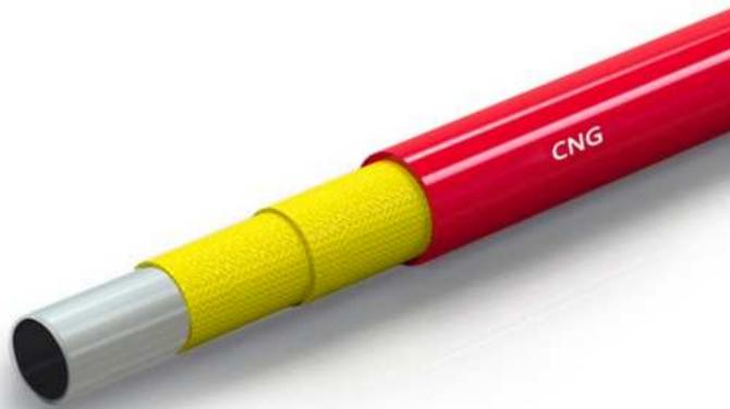
Anima interna in poliammide conduttiva, rinforzo con trecce in fibre tessili ad alta tenacità, ricopertura esterna in poliuretano ROSSO antiabrasione, microperforato.
