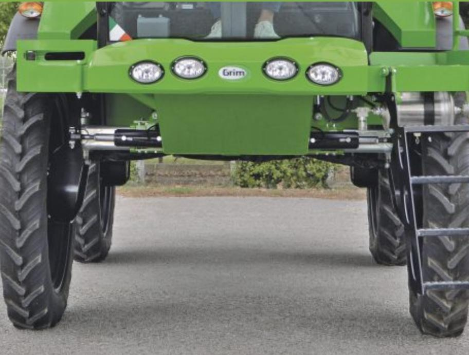
Regolazione rapida della carreggiata per adattarsi ad ogni tipo di interfila.
