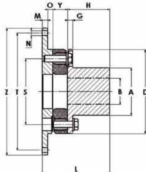
Giunto di trasmissione con elemento elastico (gomma rinforzata con tele nylon). Le flange sono in acciaio, realizzate su specifiche dei clienti e il mozzo è in acciaio ed è fornito di un foro pilota, un foro e una cava o un foro scanalato.
