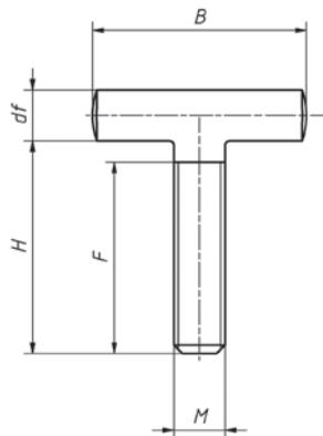
Particolare stampato a freddo utilizzato principalmente per ottenere un sistema di fissaggio snodato. Molto comune per il fissaggio di serbatoi.
