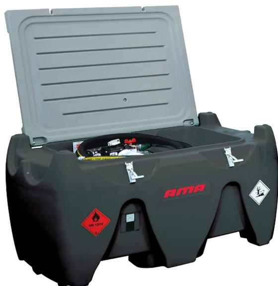
Serbatoio trasportabile in polietilene per il trasporto di benzina **omologato ADR**, completo di coperchio lucchettabile, tasche per il sollevamento a pieno con carrello elevatore, impugnature per il sollevamento a vuoto ed alloggiamenti per il posizionamento delle cinghie di fissaggio al basamento di appoggio. Tutti gli inserti sono realizzati con materiali compatibili con le benzine.
