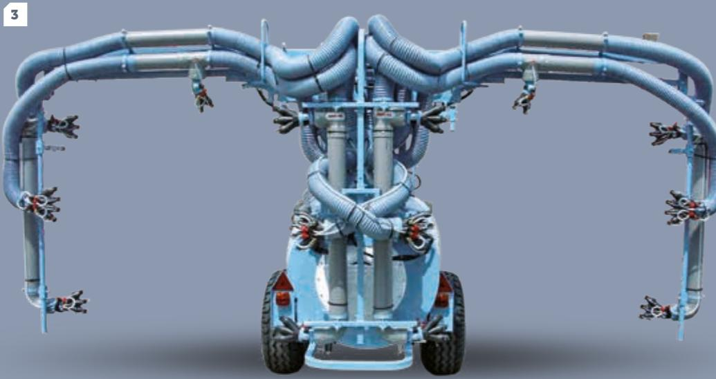
**3** IT: Versione per 2 file, completa di 8 diffusori 3 uscite, 2 diffusori a 4 uscite e 2 diffusori a 2 uscite
