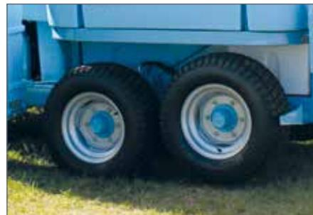
IT: Ruote tandem con bilanciere e sollevamento idraulico della ruota posteriore
