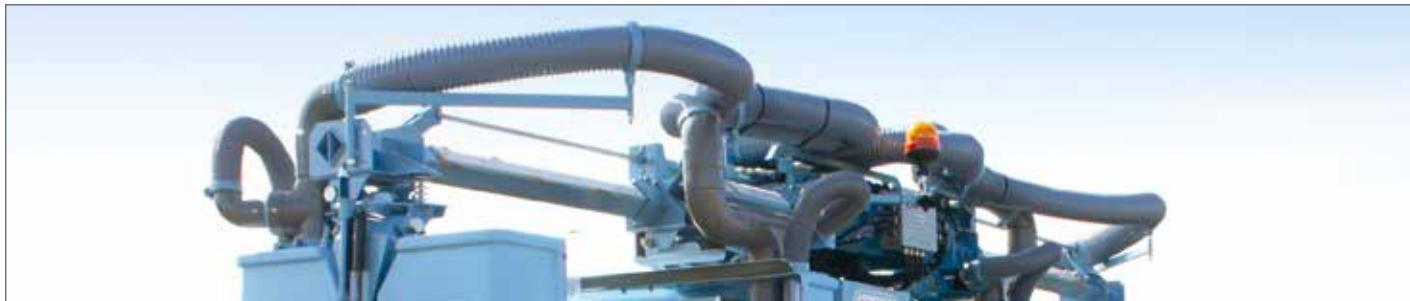
IT: Sollevamento centrale ed estensione delle braccia idraulici, per lavorare su vigneti di altezze e larghezze diverse
