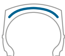
Carcassa di nuova generazione con materiali di rinforzo ad alte prestazioni
